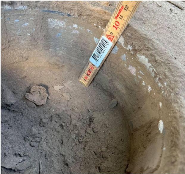
Borekerneprøve i primærvejen – Rivedalen. Ca. 15 mm AB og 75 mm GAB. Samlet asfaltopbygning på ca. 90 mm.
